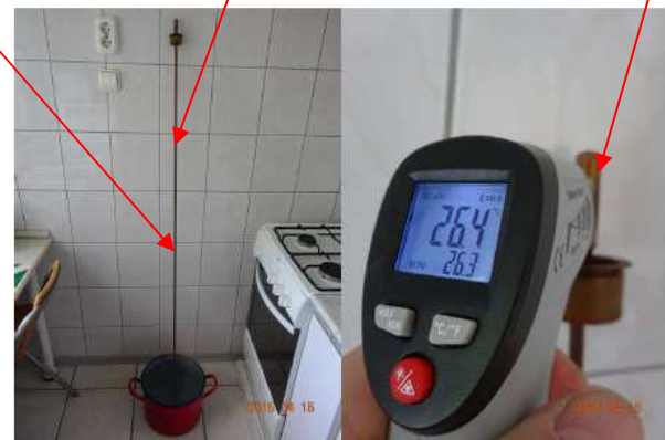
28. kép: A fazékba állított heat-pipe cső
